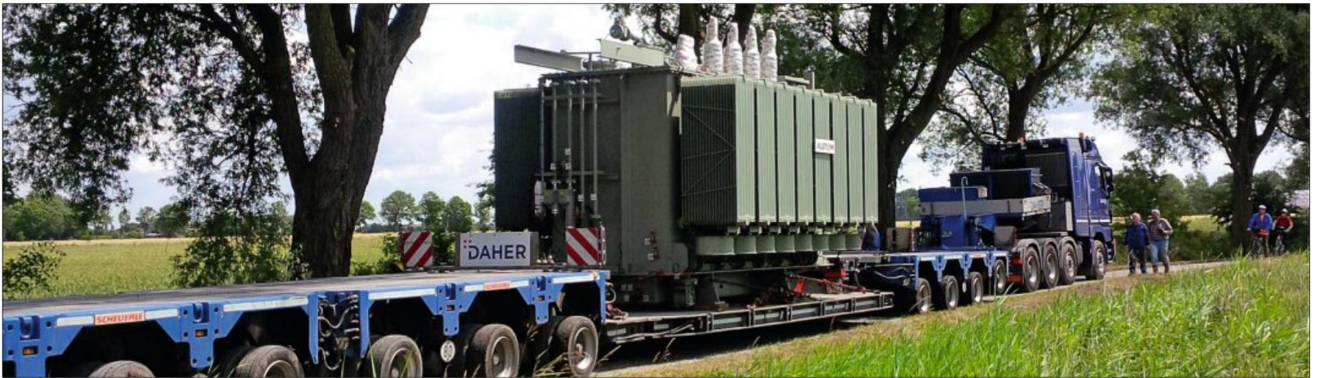
Der 86 Tonnen schwere Trafo wurde mit einem Spezialtransporter aus dem 350 Kilometer entfernten Bornheim nahe Bonn nach Eilsaum gebracht.
